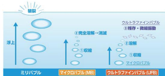
Fig. 1 ファインバブルの生成プロセス
