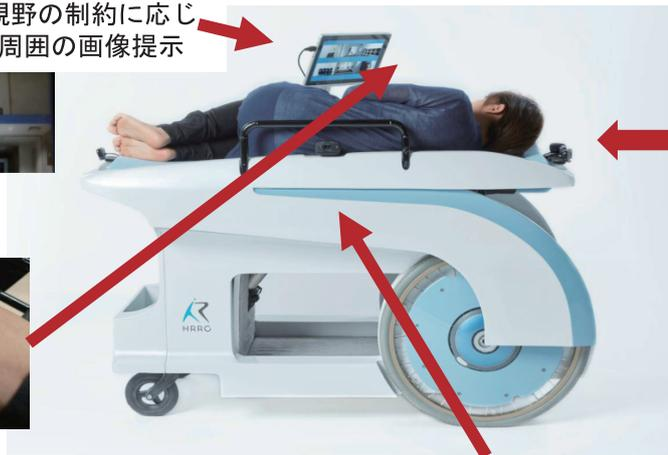
側臥位の安定的な支持機構と衝突時の防護
