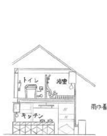
雨巾着 重力で水を送る 雨水タンク
