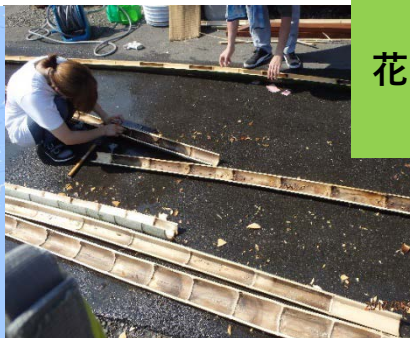
写真2 やすりかけ作業
