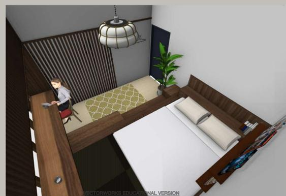
8畳も12畳同様、天井を壊し梁を見せる。布団のところだけ床を450mm(椅子と同じくらいの高さ)あげる事で、座ってくつろぐ、寝る、机で作業するなど様々な動作に対応することができる。また、日本らしさを残すため畳を敷き和モダンな雰囲気を作り上げる。
