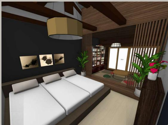
畳スペースは100mm、ベッド周りは200mm上げ、段差による空間分けをした。また畳スペースとの間に格子の仕切りを設け空間に違いをもたらすことで、宿泊者がいないときは、カフェとして畳スペースを活用することができる。天井は壊し、梁剥き出しの開放感ある宿泊スペースにした。隣の部屋とは壁を屋根の高さまで上げ完全に分けることで、プライベートをしっかりと守る。
