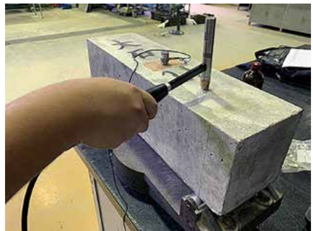
写真-2 コンクリートの固有振動数の測定
