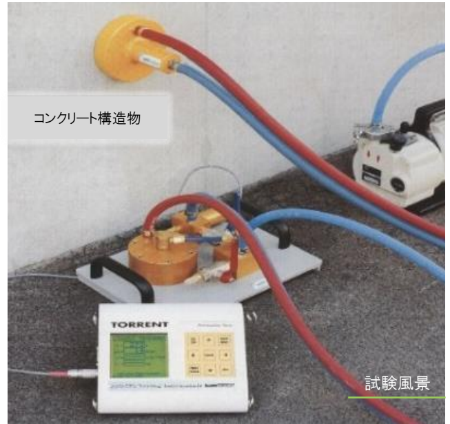
図 1 ダブルチャンバー透気性試験法の試験原理
